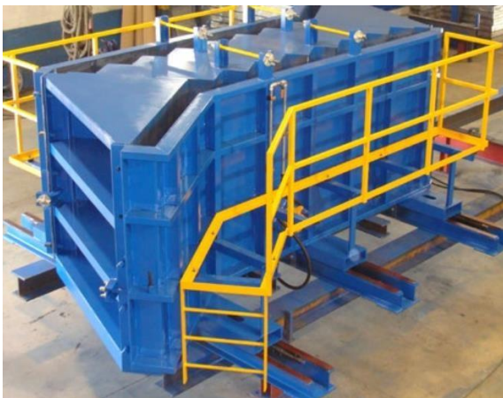
Figure 15: Moule double hydraulique pour escalier [7]
