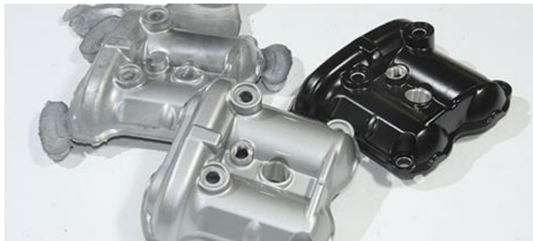
Figure 7: pièce obtenue par moulage de gravité [7]
