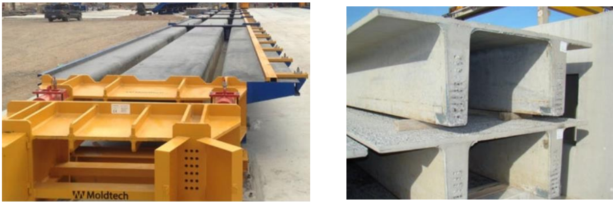
Figure 13: moule autoportant pour dalle et prédalle [9]
