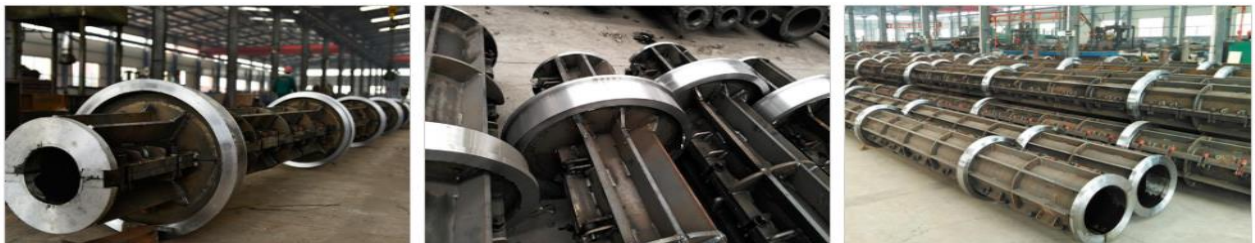
Figure 20: moule métallique pour poteau en béton [9]
