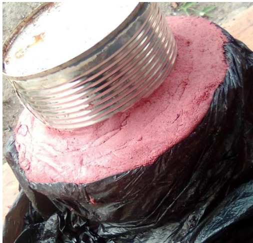
Photo 11 : moulage et compactage ; Cliché Fonkwa Noubissi A.H 09/2/2020 10 :05 / 14 :10
