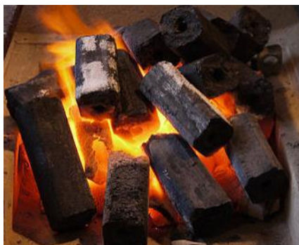
Figure 6: charbon à base de sciure de bois Christian Sales, (2003), Innovation technologique et valorisation des sous-produits des filières bois France, Montpellier.
