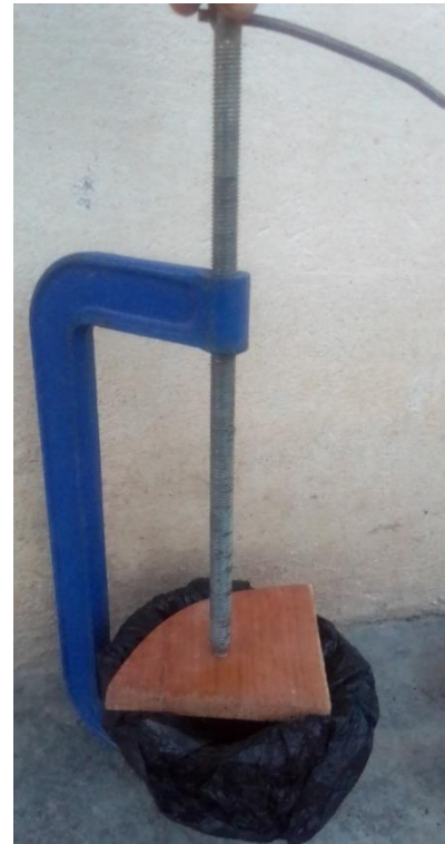
Photo 11 : moulage et compactage ; Cliché Fonkwa Noubissi A.H 09/2/2020 10 :05 / 14 :10
