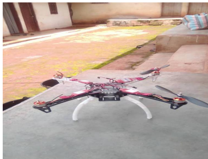
Figure 48: Fixation des moteurs et leurs contrôleurs
