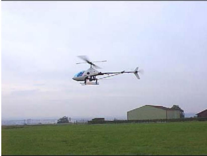
Figure 1: Hélicoptère Classique (un rotor principal et un rotor de queue)
