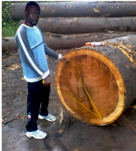
Figure 13 : Prise du diamètre sur la bille (Takoudjou, 2020)
