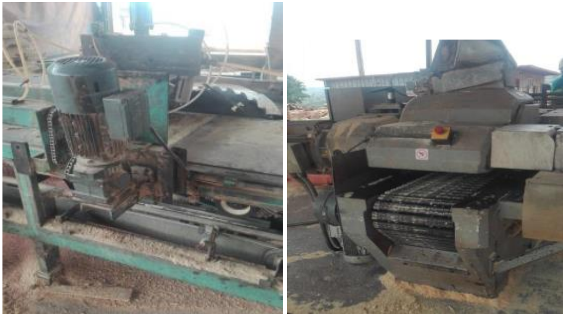
Figure 9 : Déligneuse multi et mono lame de la scierie de JDF (Takoudjou, 2020)
