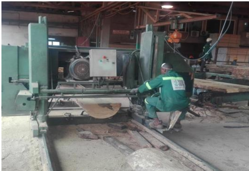
Figure 8 : Scie de tête à ruban (CD10) de l'entreprise (Takoudjou, 2020)
