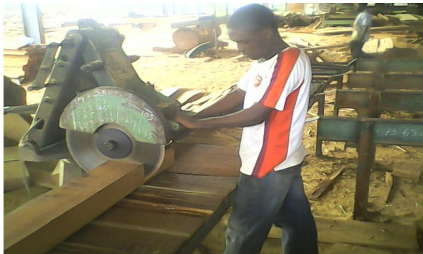
Figure 10 : Ebouteuse de type DEWAT (Takoudjou, 2020)
