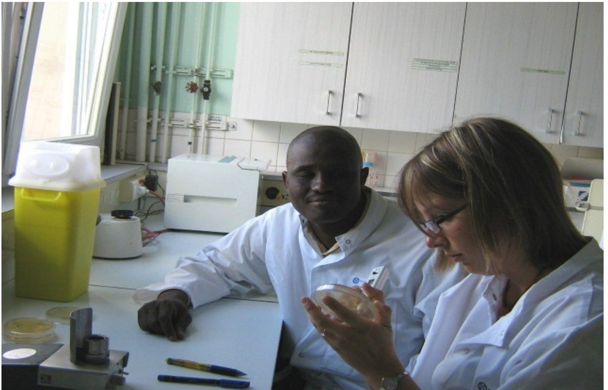
Comptage des bactéries et des moisissures à l'aide d'un compteur électronique de colonnise au laboratoire de microbiologie de l'hôpital d'adultes de Brabois (CHU de Nancy)
