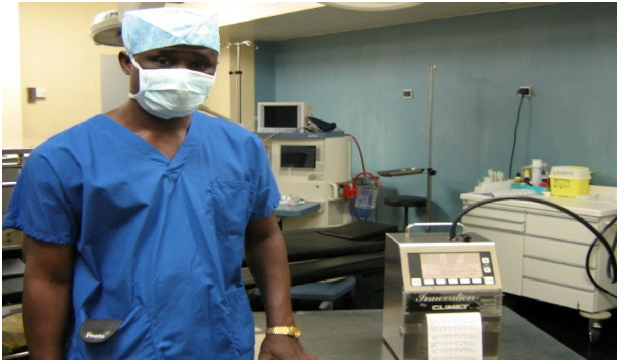
Prélèvement d'air avec le compteur particulaire dans un bloc opératoire de l'hôpital Bar- Le-Duc (à 100 km de Nancy)
