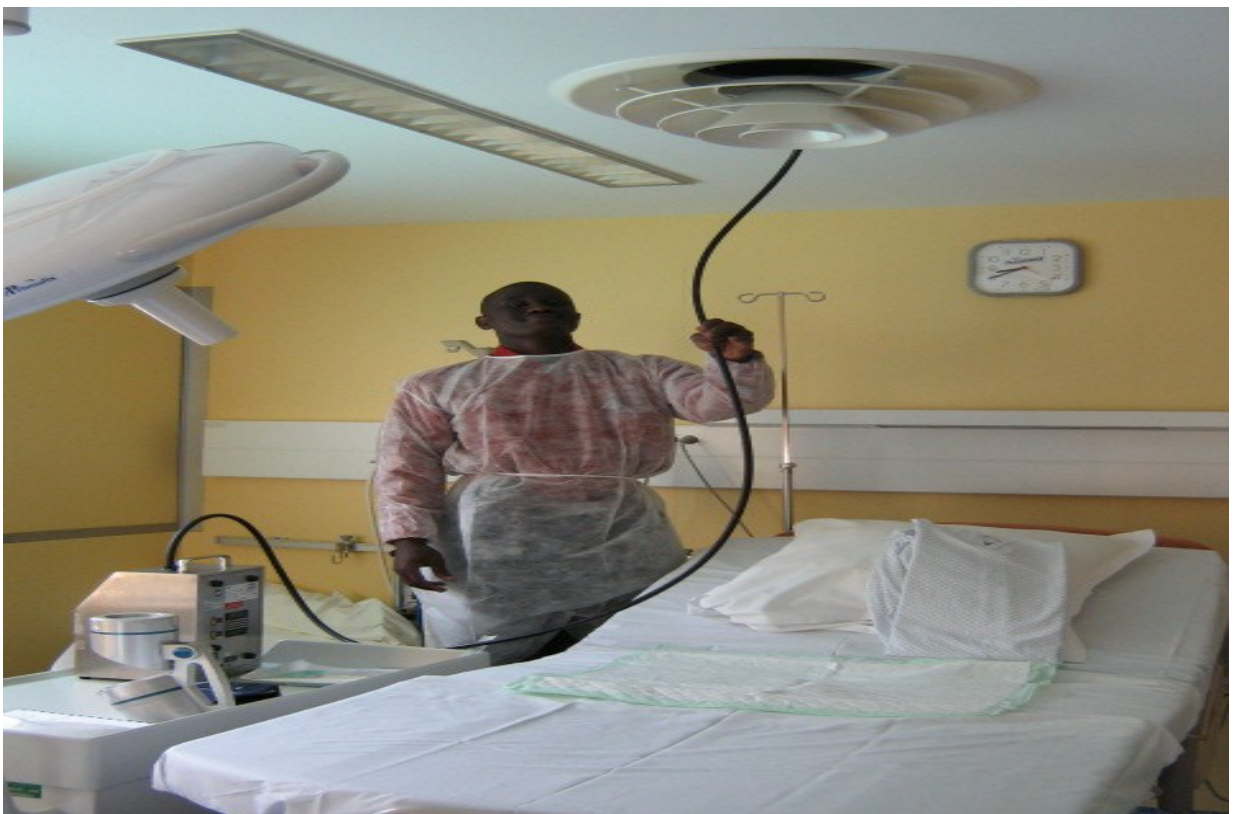
Prélèvement d'air avec le compteur de particule dans une salle d'accouchement de l'hôpital Toul (à 50 Km de Nancy).
