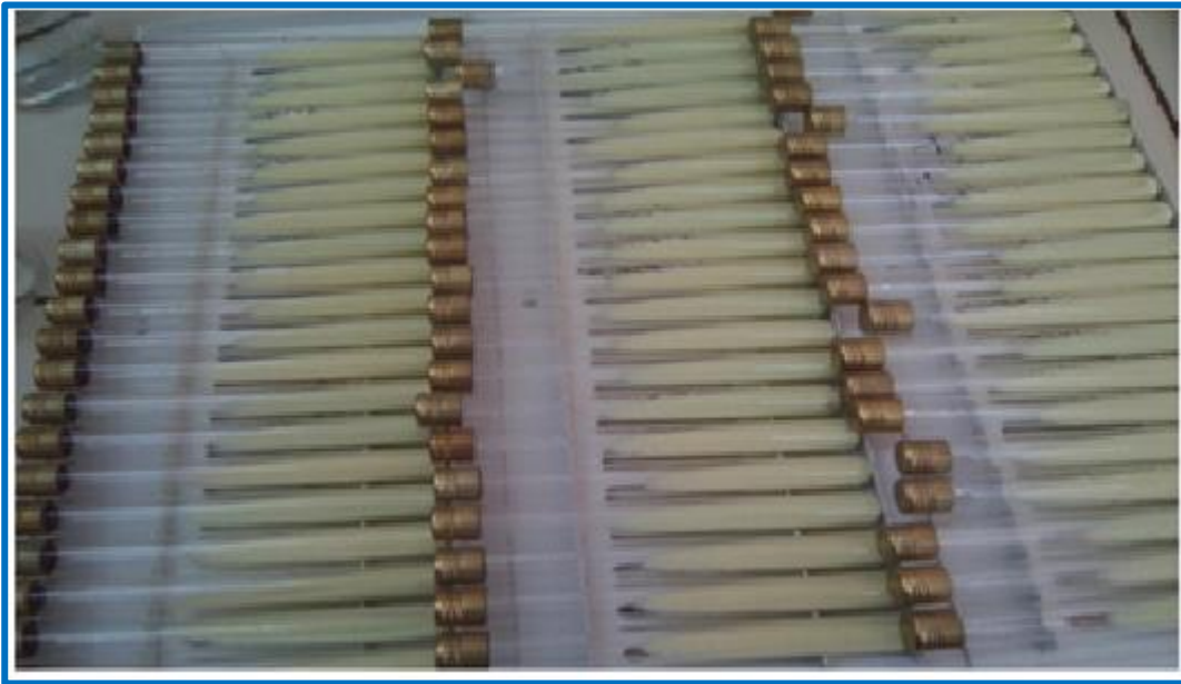
Figure 17: Milieux de Lowenstein Jensen coagulés, disposés sur des clayettes (Photo KA, URM, INSP/Centre MURAZ).
