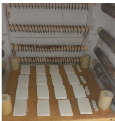
Figure 10: Éprouvette dans le four après frittage
