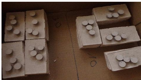
Figure 9: Eprouvettes parallélépipédiques et cylindriques
