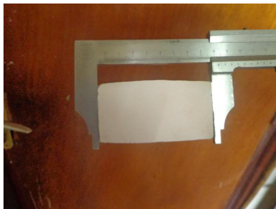
Figure 11: Mesure des paramètres de l'éprouvette à l'aide du pied à coulisse.
