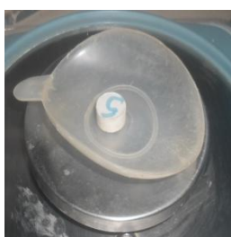
Figure 12: Mesure de la masse des éprouvettes avant et après immersion pendant 24h.
