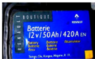
FIGURE 2.4 – Présentation des caractéristiques électriques d'une batterie d'accumulateur
