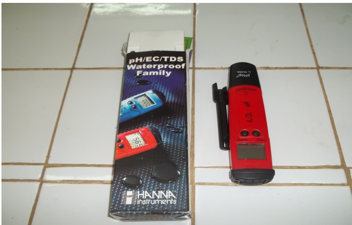
Photo 7: pHmètre utilisé pour la mesure de pH des échantillons.
