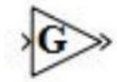
FIGURE 2.5 – Symbole du Gain dans Simulink.
