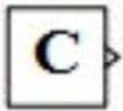
FIGURE 2.4 – Symbole d'une constante dans Simulink.
