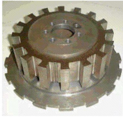
FIGURE 1.6 – Rotor d’une machine à réluctance variable à double saillance-alternodémarrreur Valeo-LESIR (MILLER 1989).
