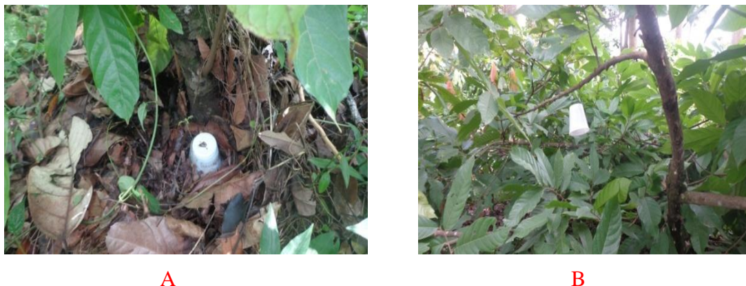
Figure 10. Thermohygromètre installé dans la litière (A) et accroché sur une branche (B)
