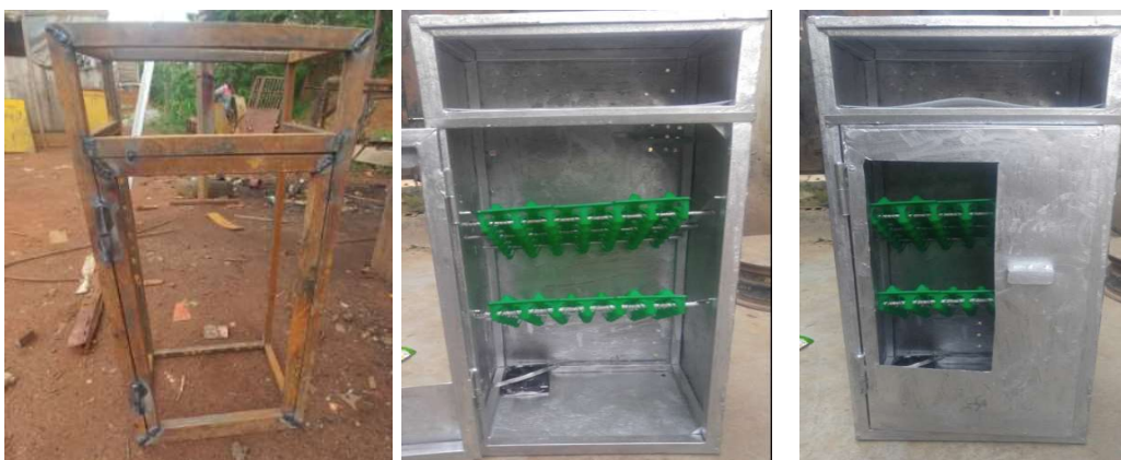
Figure 28 : Caisse en feuilles métalliques de notre incubateur
