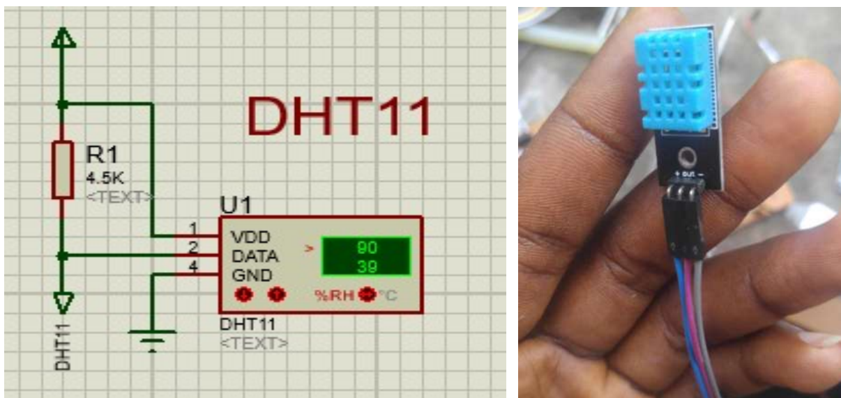
Figure 5 : Le schéma d'un DHT11.
