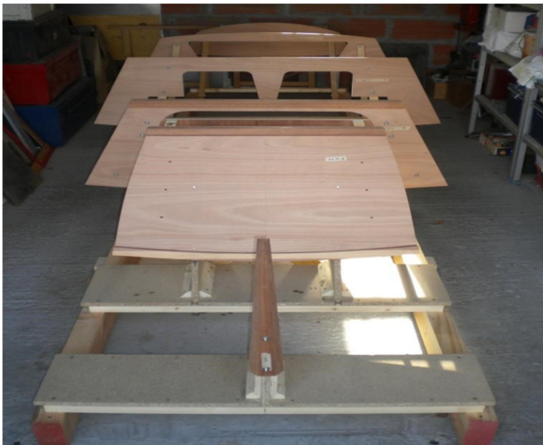
FIGURE 3.1 – réalisation du bati
