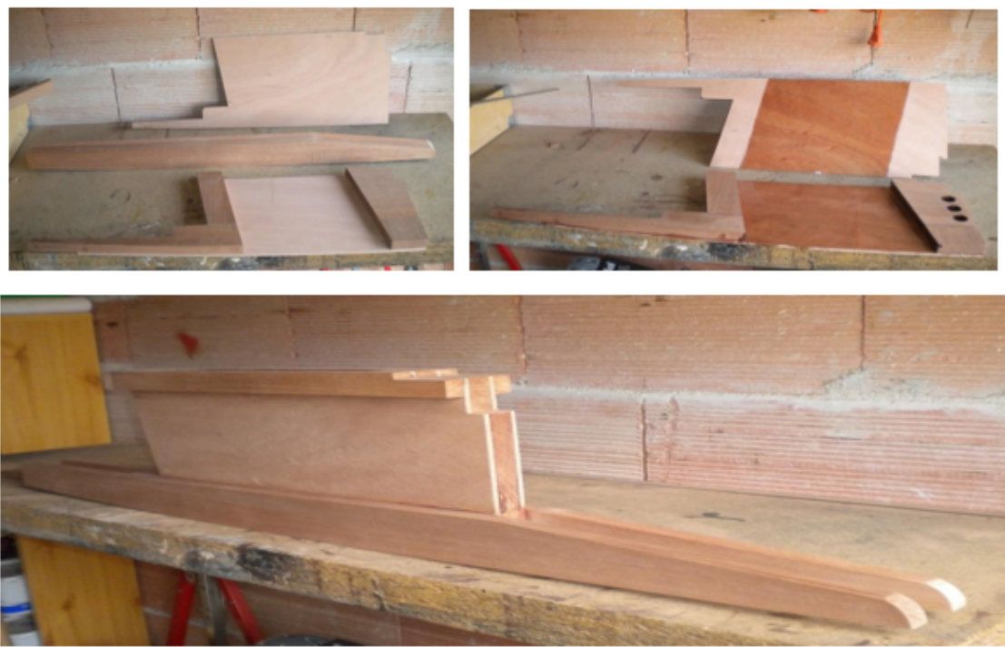
FIGURE 3.2 – réalisation du puits de dérive
