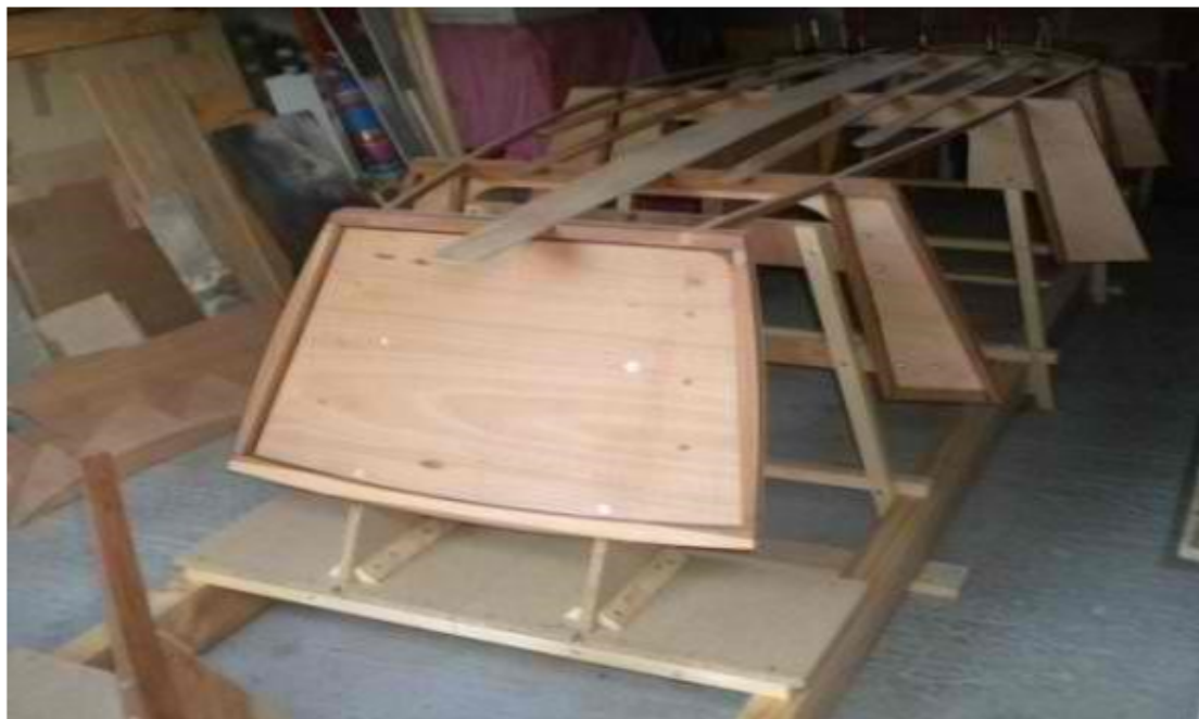
FIGURE 3.3 – Mise en place des renforts de fond
