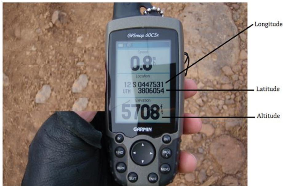
Figure 2.10- Ecran d'affichage des positions d'un GPS en mode UTM [36]
