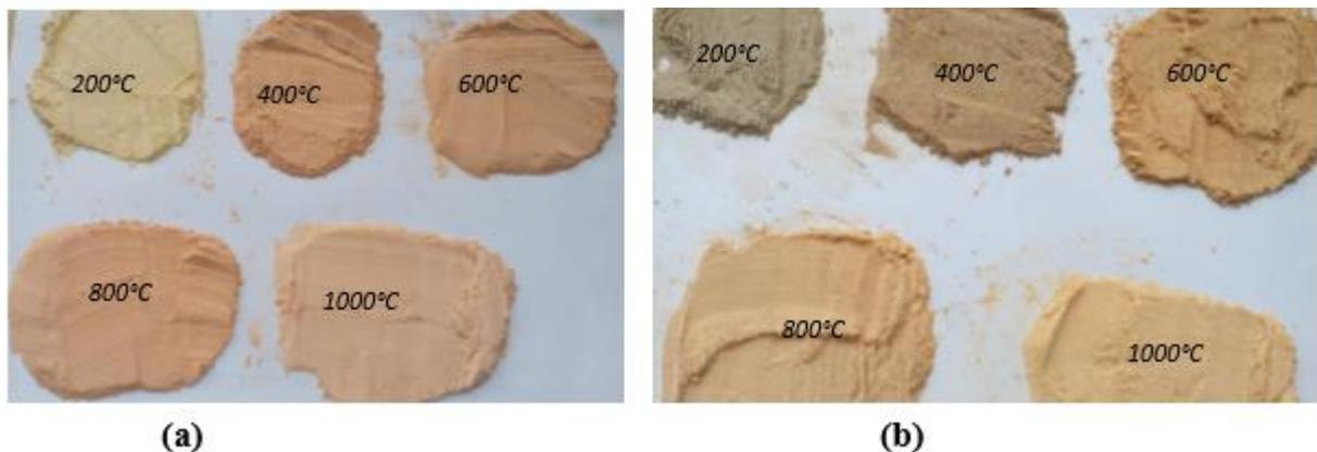
**Figure 9 : Aspect des échantillons après la cuisson de KK(a) et KG(b).**
