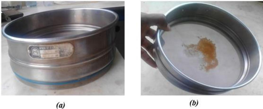
**Figure 5 : Tamis AFNOR de maille 160  $\mu\text{m}$  (a) et le refus ( $\varnothing > 160 \mu\text{m}$ ) (b).**
