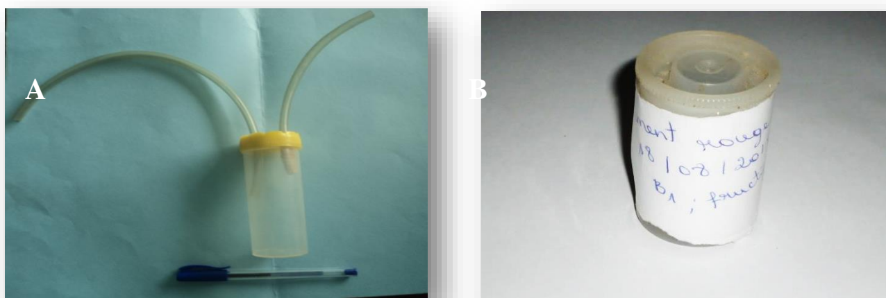
Figure 7. (A) Aspirateur à bouche, (B) Pilulier étiqueté utilisés dans la capture des insectes en champ
