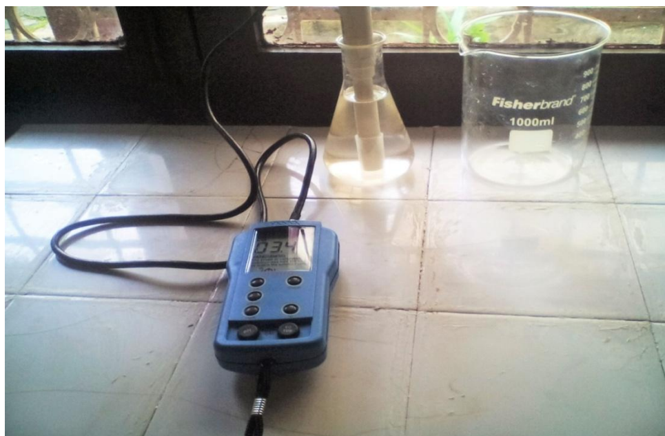
Figure 17 : Multimètre pH/conductivité/sels totaux dissous/température, Hanna HI9811-5
