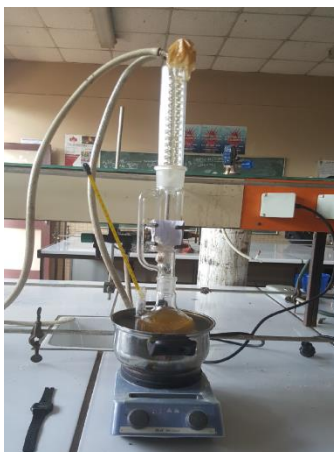
Figure 15: Schéma du montage de chauffage à reflux pour la réaction de transestérification
