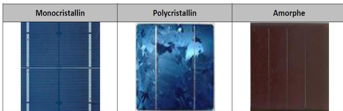
Figure 1.2: Différents types de cellules photovoltaïques au silicium (Kheridla & Khineche 2014)
