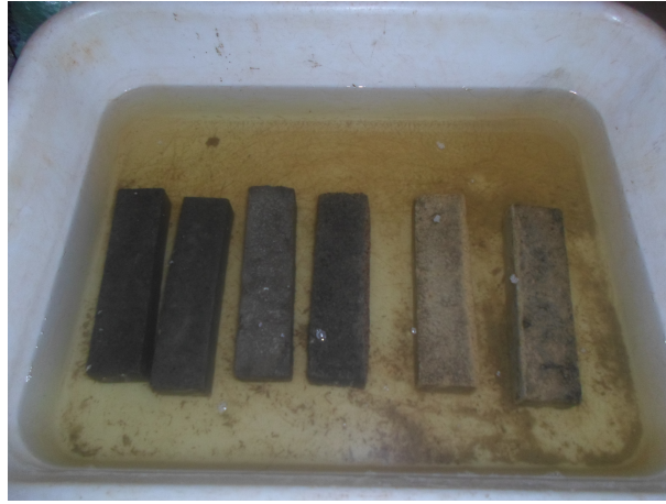
FIGURE 2.16 – Dispositif expérimental de l'absorption d'eau par immersion .
