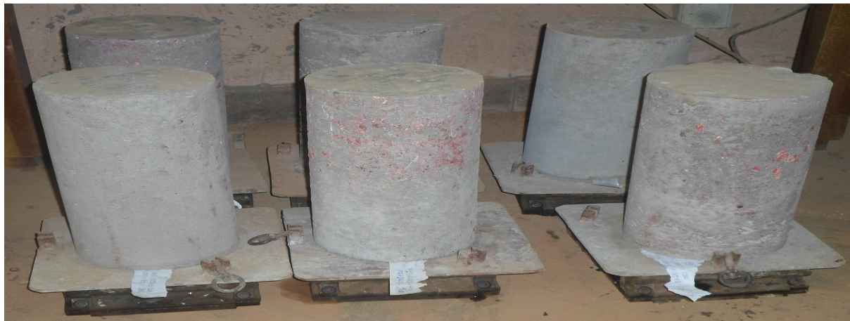
FIGURE 2.12 – Conservation des éprouvettes moulées.
