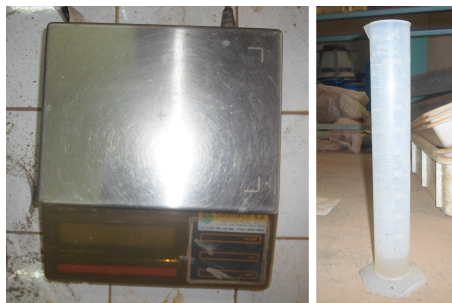
FIGURE 2.6 – Balance Sartorius et éprouvette graduée de 1000 mL.
