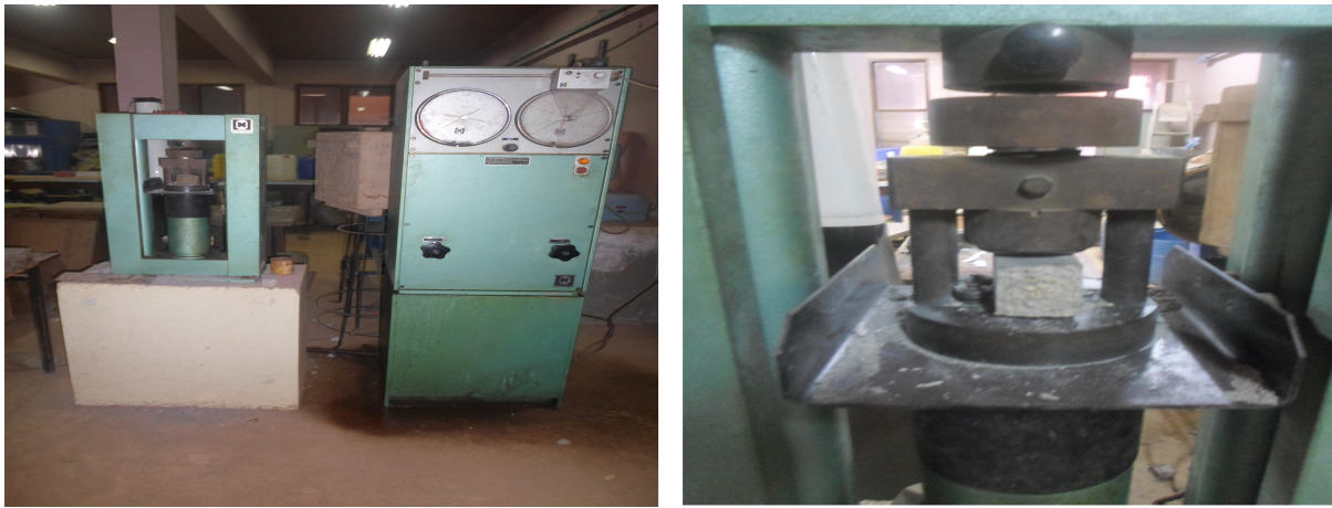
FIGURE 2.15 – Dispositif expérimental de l'essai de compression.
