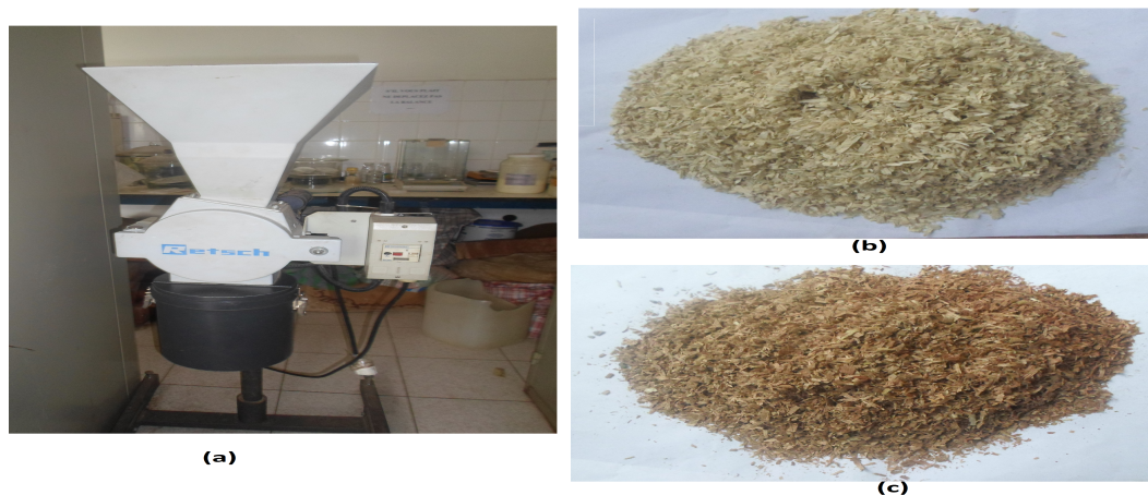
FIGURE 2.4 – (a) Broyeur à lame ; Copeaux réduits : (b) Ayous (c) Sapelli.
