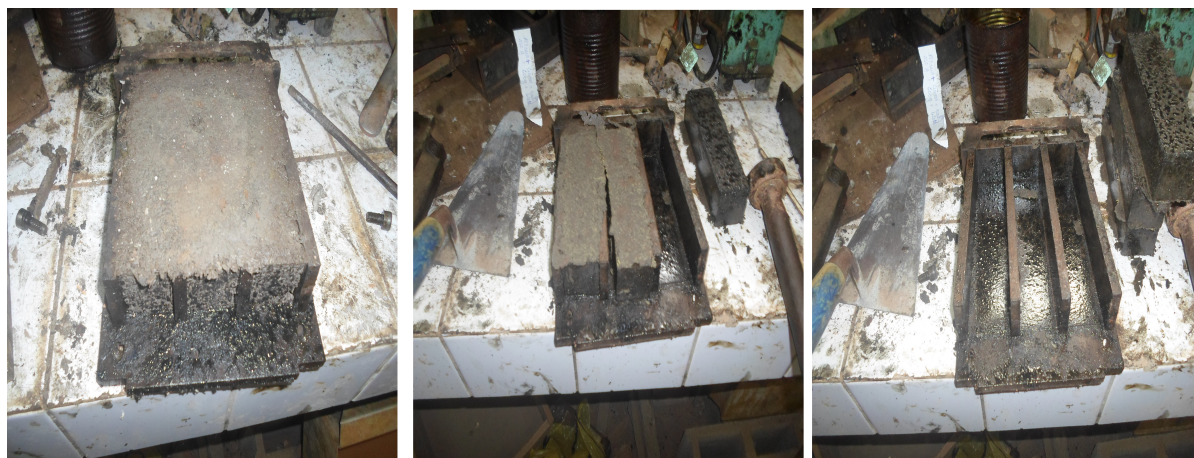
FIGURE 2.13 – Démoulage des éprouvettes.
