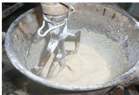
FIGURE 2.9 – Malaxage des additifs et du métakaolin.
