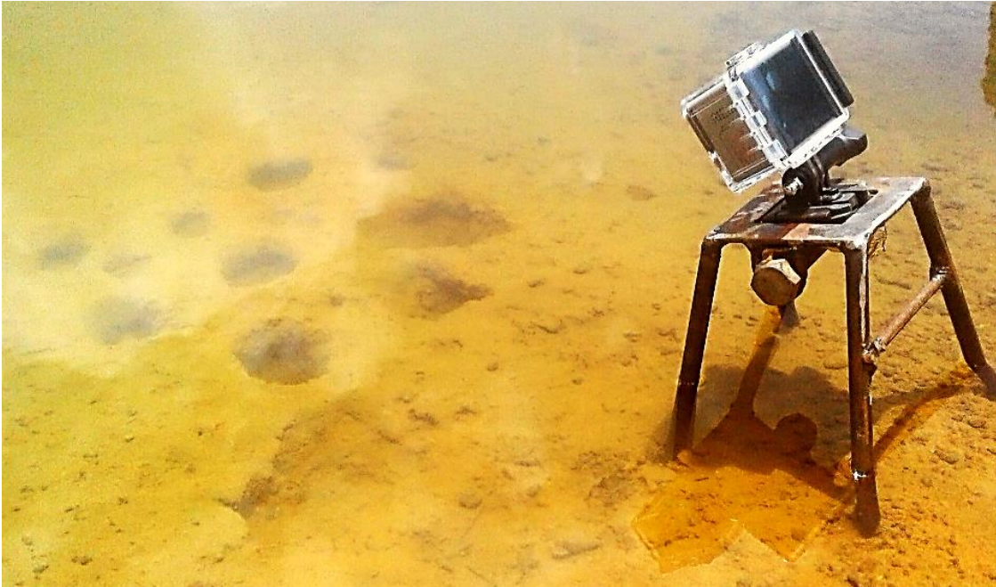
Figure 17 : Vue de la disposition d'une caméra immergée pour la vidéosurveillance des nids dans le lac de barrage de Buyo (Côte d'Ivoire).
