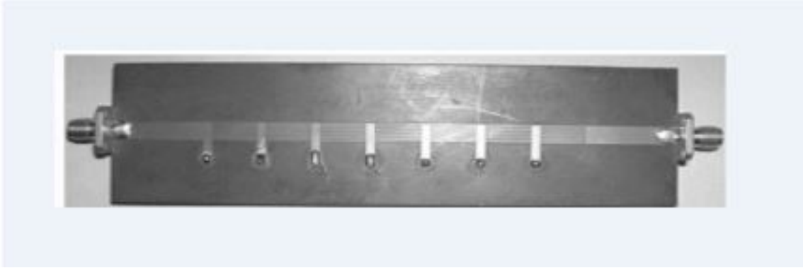
FIGURE 1.11 – Image du prototype des lignes CRLH fabriquées en technologie micro-ruban et composées de 7 cellules unitaires [14]
