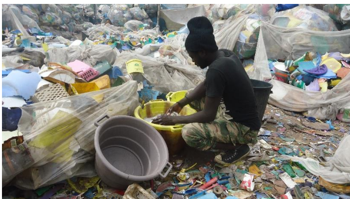
ANNEXE 16 : Image : Une étape de recyclage des plastiques durs : le lavage
