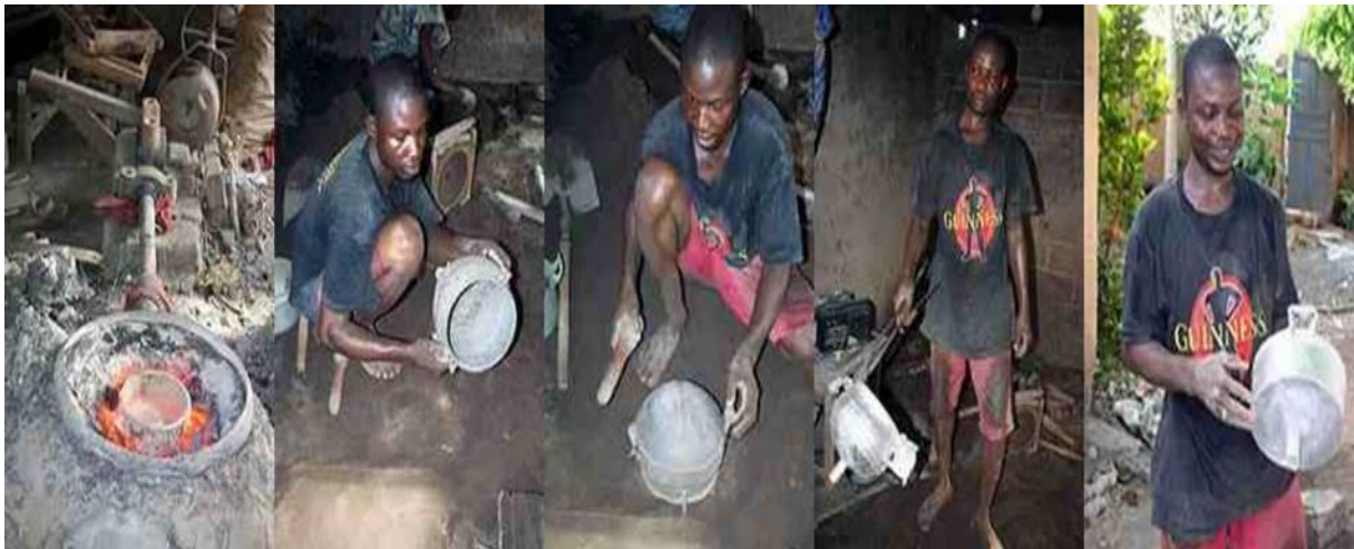
ANNEXE 14 : Image : Fonderie de l'aluminium en ustensiles de cuisine
