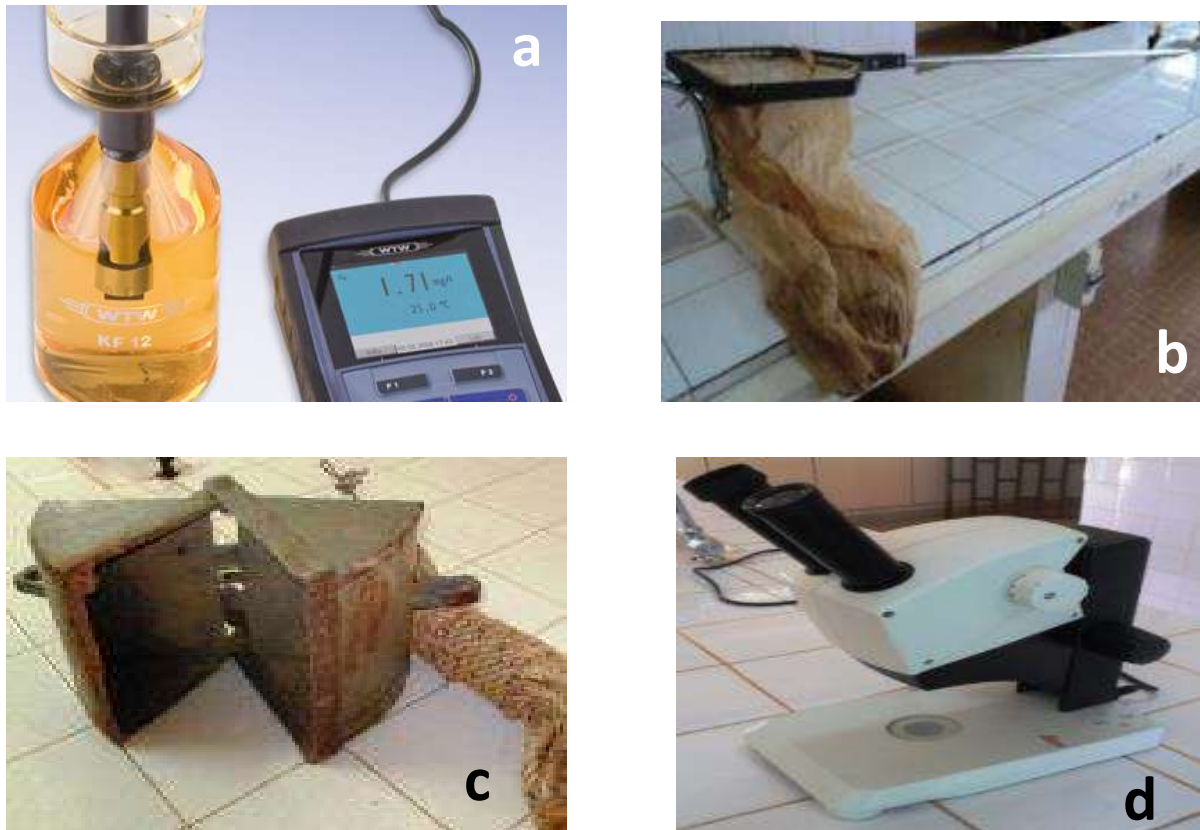
Figure 4 : Photographies du matériel utilisé pour la mesure des paramètres physico-chimiques et l'échantillonnage des macroinvertébrés de la lagune Aghien.
