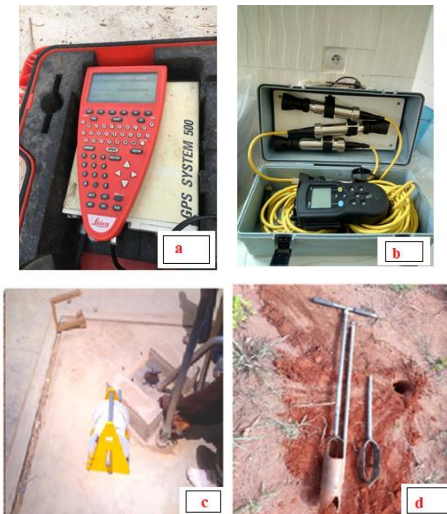
Figure 14 : Quelques outils de terrain : (a) GPS de localisation ;(b) Multiparamètre ; (c) Sonde piézométrique ; (d) Tarière.
