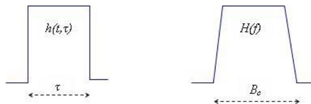
Figure 3. 3 Etalement temporel et bande de cohérence du canal
