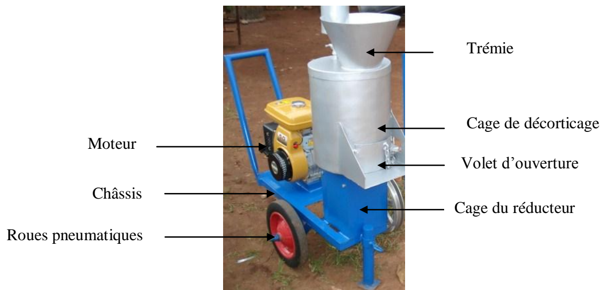
Photo 3-1: Décortiqueuse verticale à palettes
