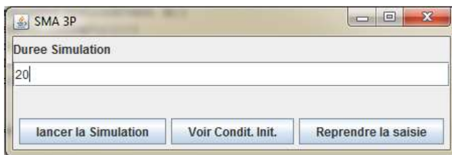
Figure 70 : Fenêtre pour la saisie de la durée de la simulation. Dans cette fenêtre l'utilisateur, avant de lancer la simulation, a la possibilité de consulter un fichier au format RDF dans lequel sont inscrits les conditions initiales qu'il avait auparavant saisies (voir la figure 68), pour en vérifier la rectitude. Pour cela, il lui suffit de cliquer sur le bouton « Voir Condit. Ini. ». Il peut aussi reprendre la saisie ou sinon lancer la simulation.
