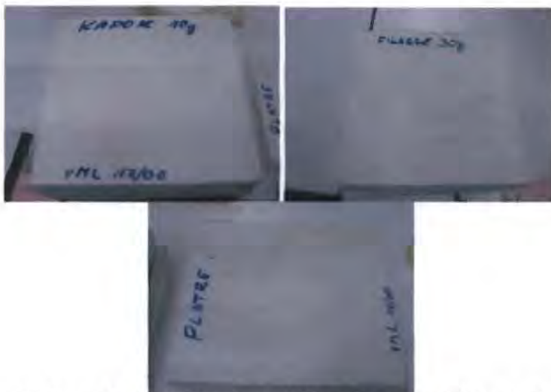
Figure 44 : Echantillons de Kapok + plâtre, Filasse + plâtre et de plâtre tout seul
