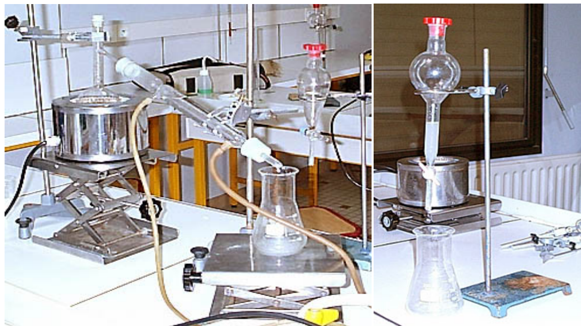
Figure 22 : Entraînement à la vapeur d'eau ; vue du montage à réaliser
