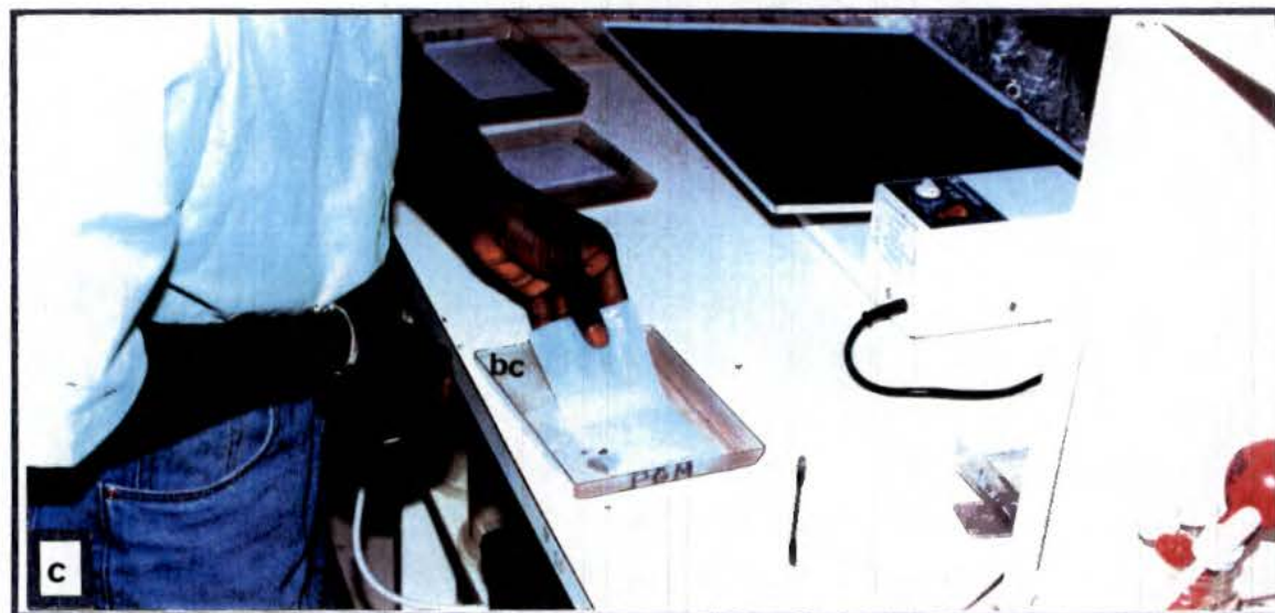
Figure 13: Révélation: (a), coupe du gel en tranches de 1 mm d'épaisseur ; (b), prélèvement de la tranche ; (c), dépôt de la tranche dans le bac à coloration. tr = tranche de gel de 1 mm d'épaisseur ; bc = bac à coloration
