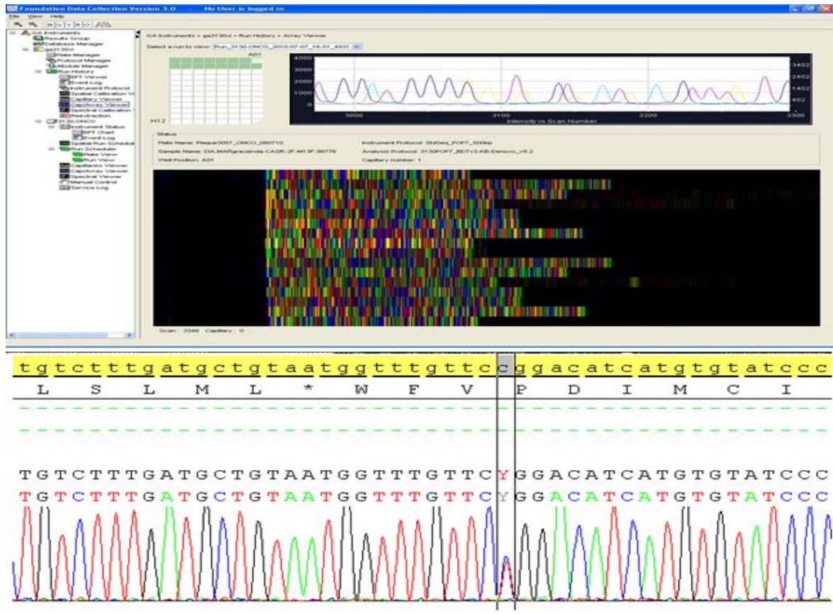
Figure 17 : Schématisation d'un résultat de séquençage après traitement informatique. Chaque fragment de taille variable passe devant un laser capable d'exciter le fluorochrome marquant le ddNTP qui émet un signal à une longueur d'onde spécifique. Ce signal est converti par un algorithme en fluorogramme coloré visible au niveau de la station de travail du séquenceur (fenêtre du haut). Les fluorogrammes sont assemblés donnant la séquence du fragment étudié (fenêtre du bas). La séquence est analysée sur le logiciel SeqScape 2.5 (en bas), elle est comparée à la séquence de référence (en jaune).
