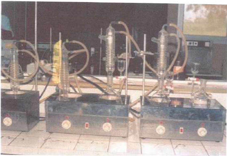
Fig.11 : Appareil à reflux constitué de ballon à fond plat de 250 m, à fond rodé (2*)
