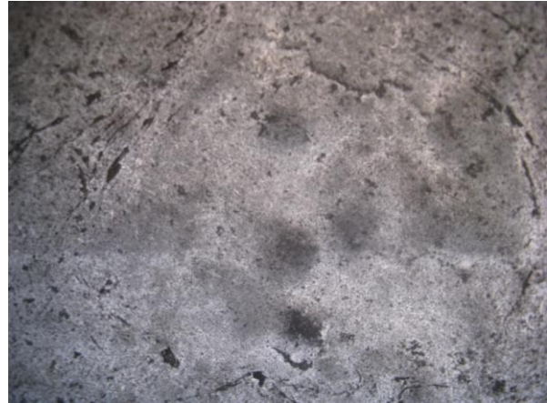
b : attaque corrosive de la paroi intérieure d'une marmite en aluminium recyclé
