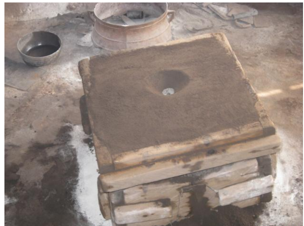
b : Moule prêt pour la coulée
