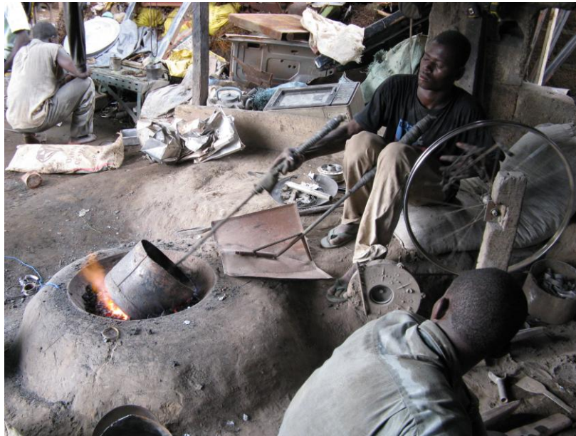
Figure III. 1 : Dispositif de recyclage de l'aluminium dans un atelier artisanal
