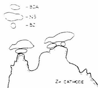
Fig. I.3 : Représentation schématique de l'adsorption des espèces associées[28]
