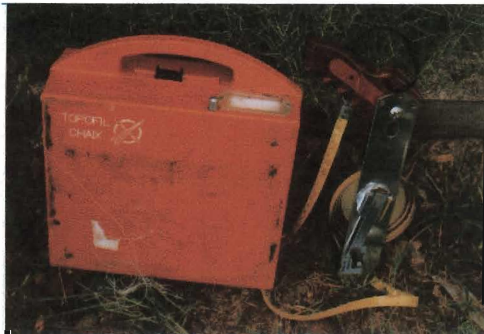
Photo 4. Topofil "CHAIX" à deux bobines (à gauche) et chaîne en acier de 20 m à (à droite).
