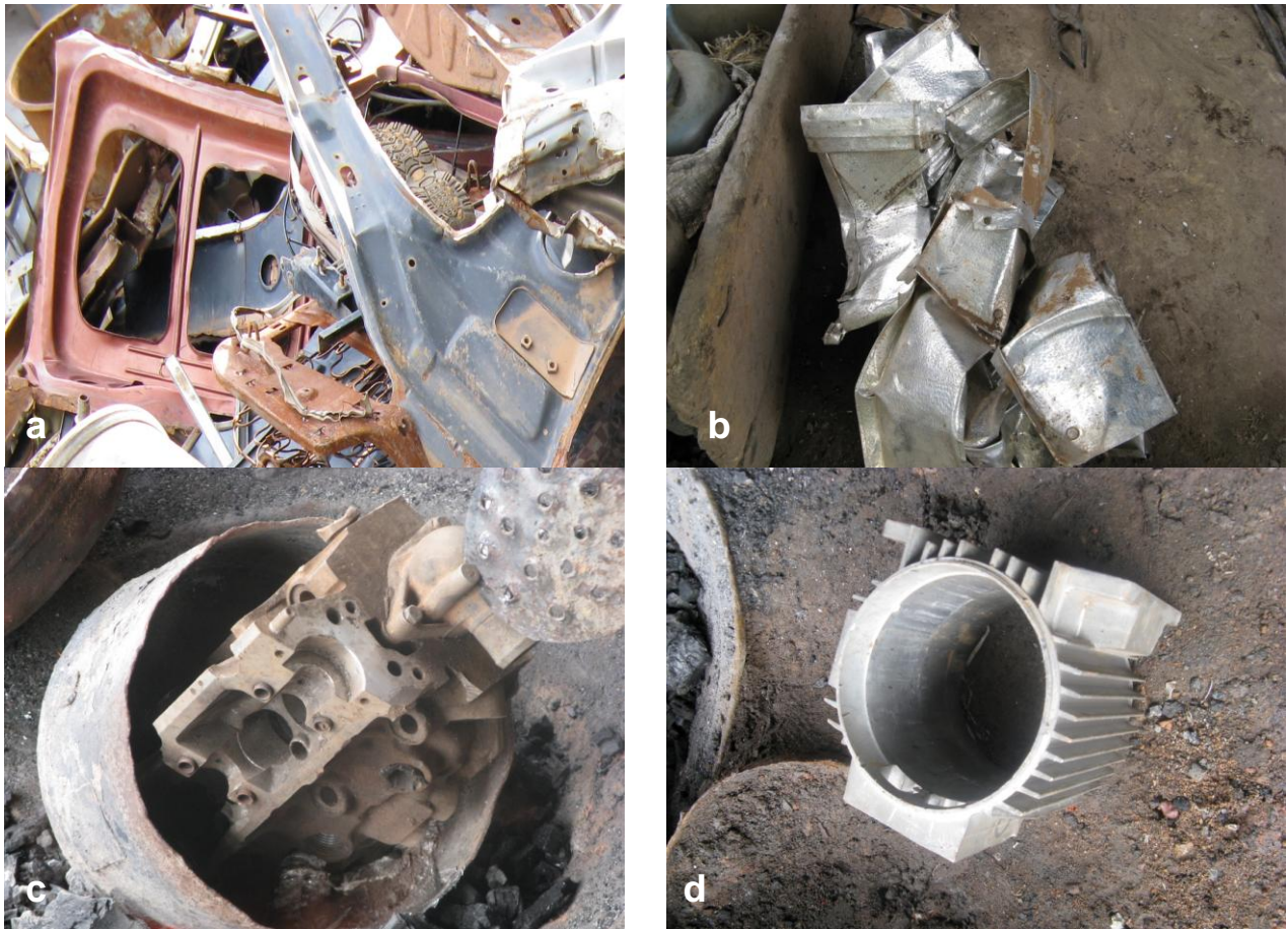
Figure i.2 : Déchets d'objets en aluminium servant à la fabrication des marmites
