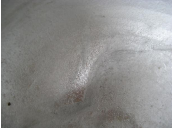
a : Fond d'une marmite neuve en aluminium recyclé
