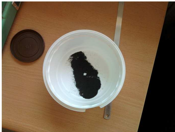
Image IV.6. Limaille de fer utilisée comme particules
