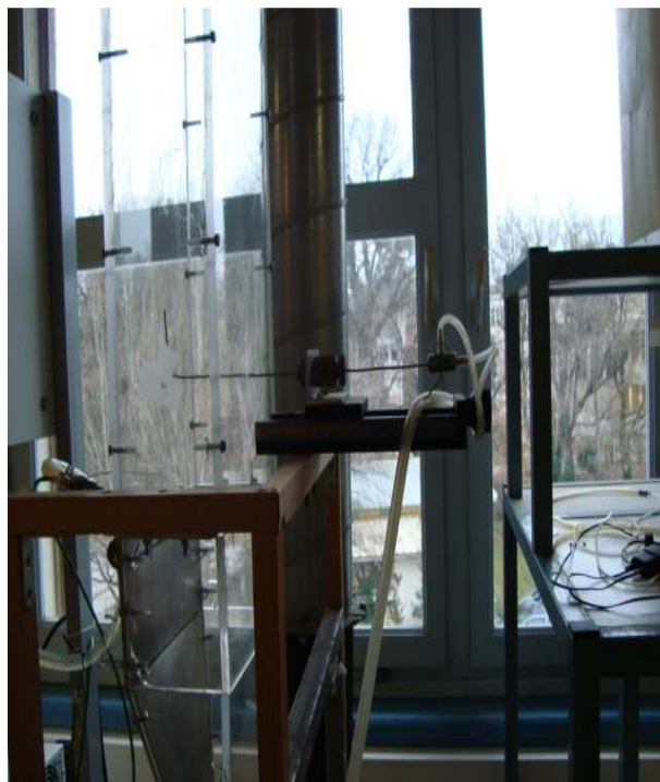
Image IV.5 Tube de Pitot monté sur l'entrée du venturi
