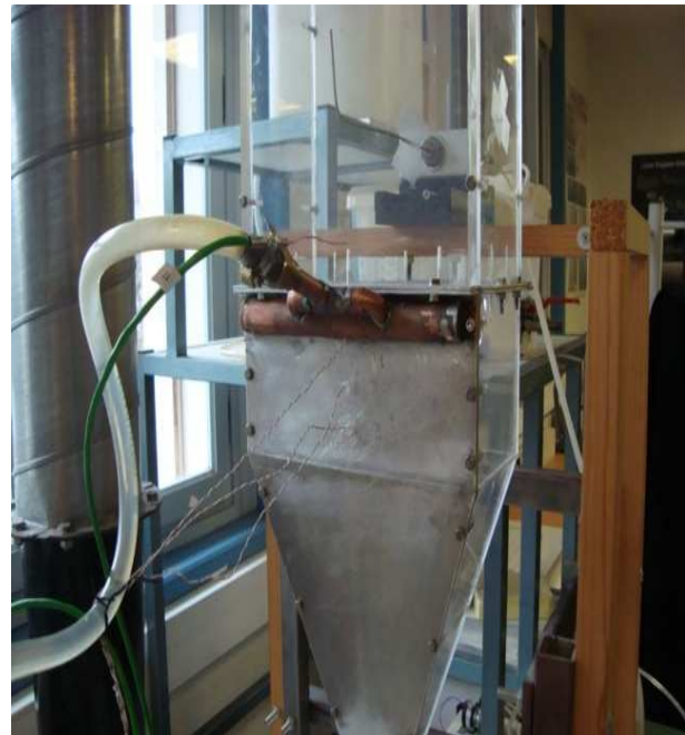
Image IV.2 Système d'injection d'eau et thermocouples
