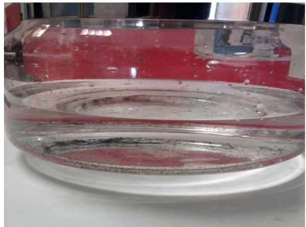
Image IV.9. L'eau recueillie à la sortie du venturi contenant les particules piégées (vue 2)
