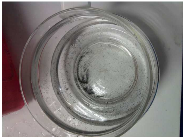
Image IV.8. L'eau recueillie à la sortie du venturi contenant les particules piégées (vue 1)
