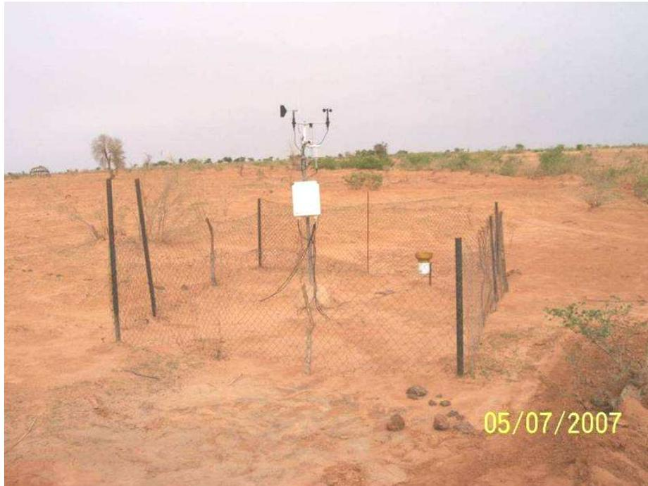
*Photo 7: Station météorologique type Campbell avec divers capteurs*
