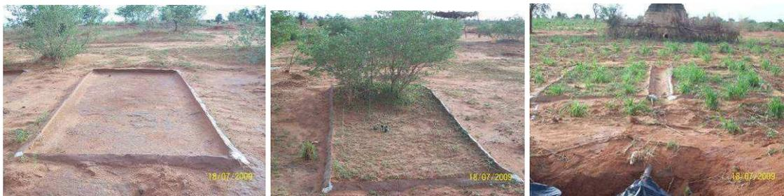
**Photo 73: Parcelle de mesure d'érosion sur un état de surface de croûte d'érosion dans le bassin versant du kori Boubon**
