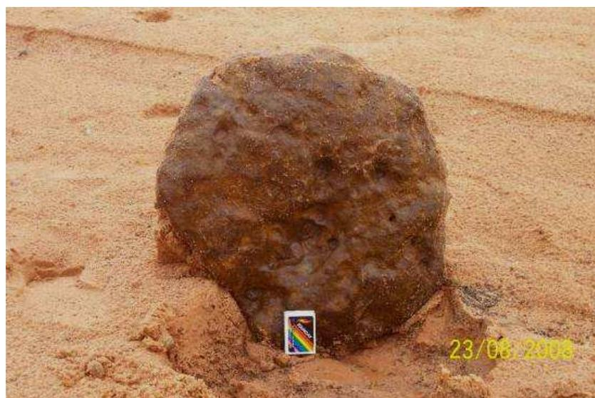
*Photo 89: Bloc de cuirasse de plus de 13 cm de diamètre emporté par les eaux et déposé au niveau du profil en travers N°4*
