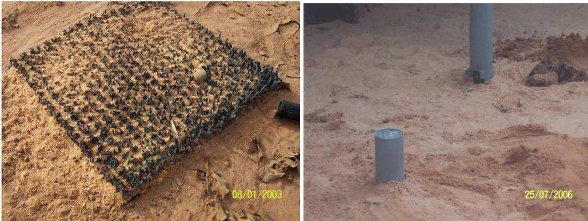
*Photo 11: Tapis et trappes à sédiments installés dans le bassin versant du kori Boubon*
