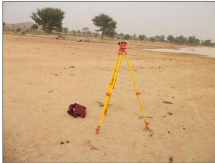
Photo 5: nivellement direct à l'aide du niveau altimétrique sur un cône alluvial
