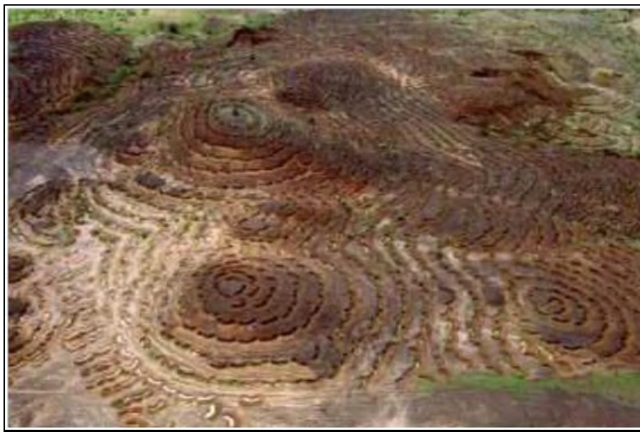
Photo 21: vue aérienne des tranchées collinaires dans le cadre du projet intégré de Keïta (F. Paladini 1989 in Malagnoux, 2004)
