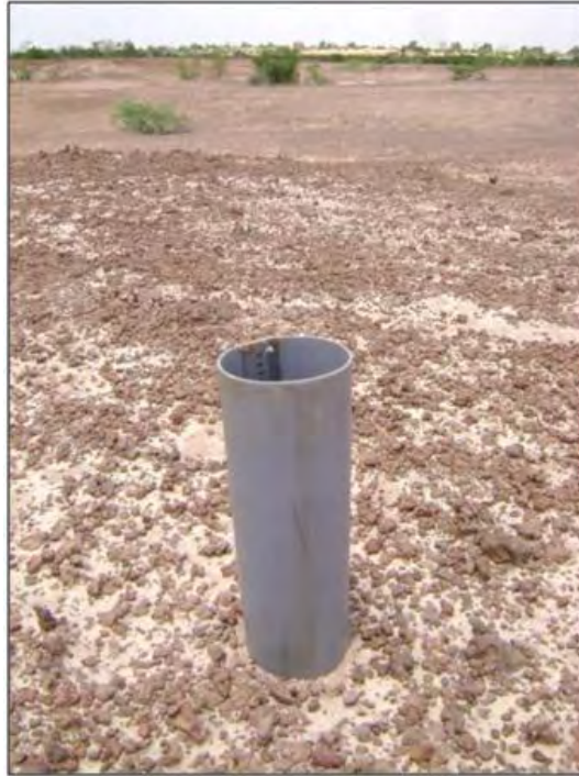
Photo 4: test d'infiltration au cylindre sur une croûte gravillonnaire
