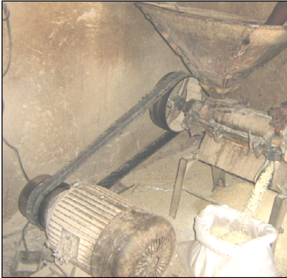
Figure 1-8: Une décortiqueuse mécanique de type Engelberg (Ouagadougou, 2010)
