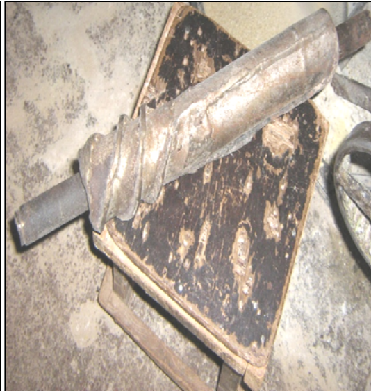
Figure 1-9: Axe rotatif effectuant le décortilage des grains (Ouagadougou, 2010)
