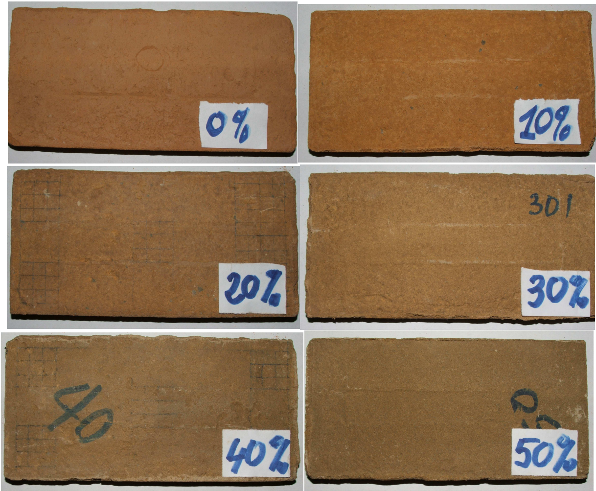
Figure 59 : Image de la variation de la couleur des briquettes en fonction du ciment
