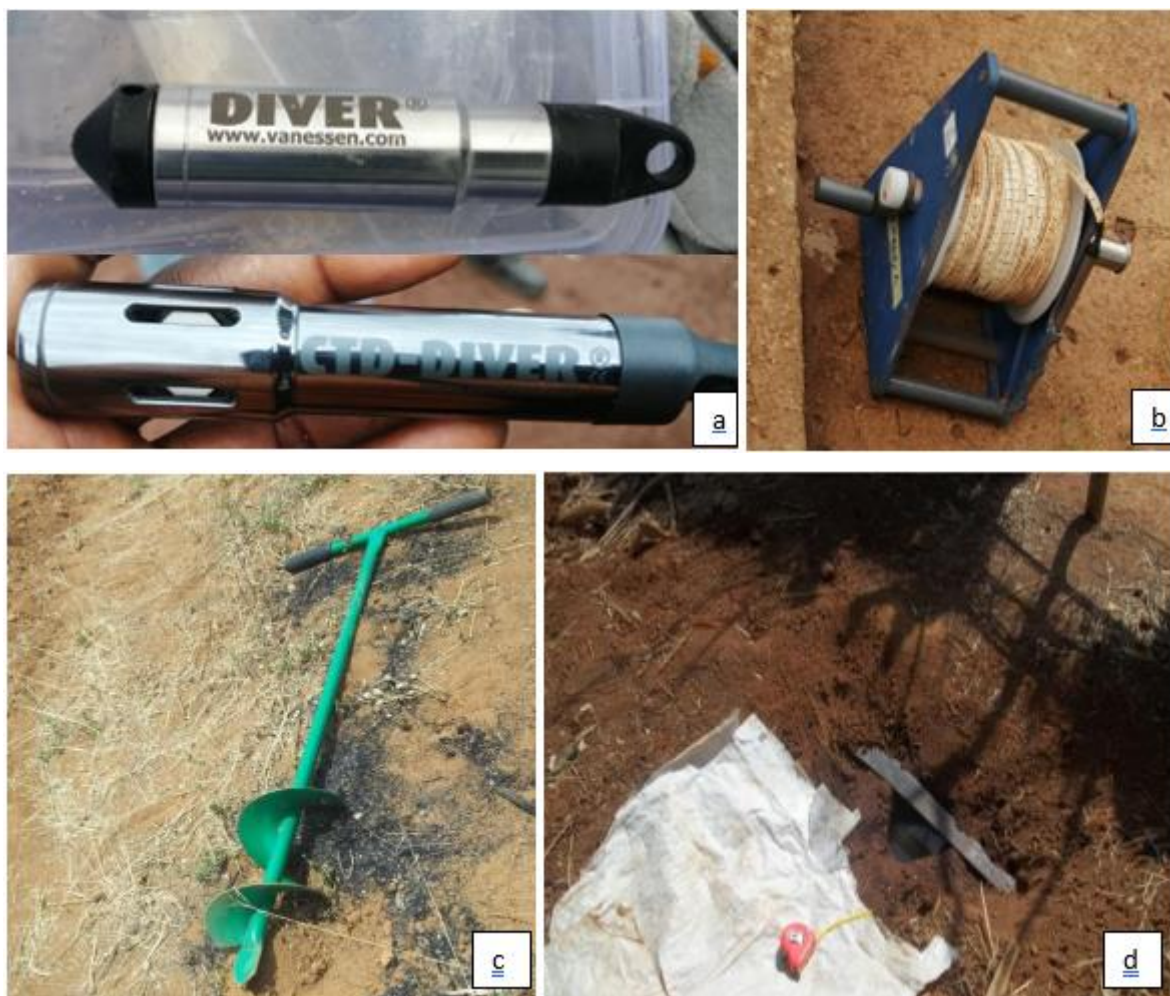
Figure 8 : Présentation en (a) des datas loggers pour enregistrement automatique ; en (b) de la sonde piézométrique lumineuse pour enregistrement manuel ; en (c) de la tarière manuelle et en (d) d'un trou de tarière.
