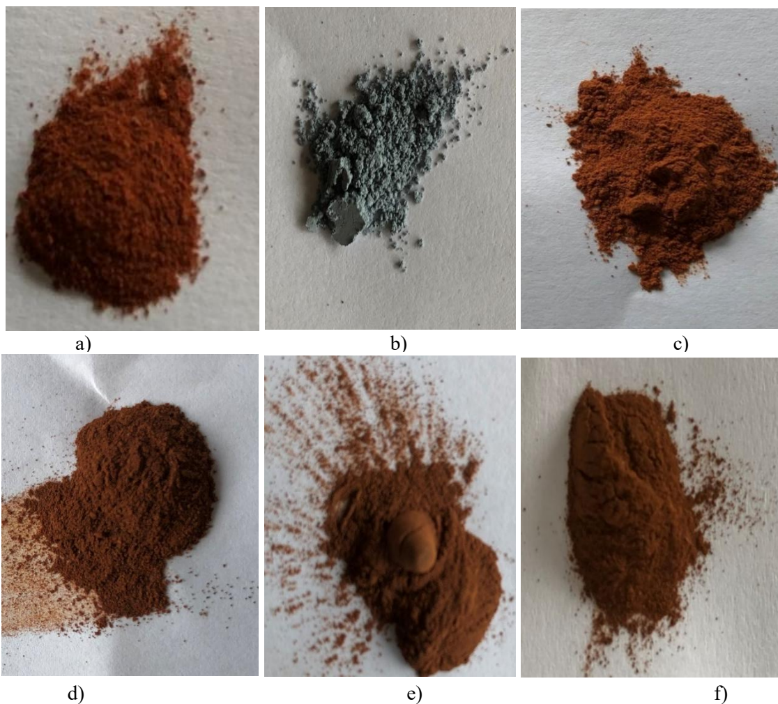
Photo 1: Aspect physique des succinates métalliques synthétisés : a) FeSuc ; b) CrSuc; c) FeCrSuc- 1 (4 %) ; d) FeCrSuc-2 (8 %) ; e) FeCrSuc-3 (11 %) ; f) FeCrSuc-4 (13 %)
