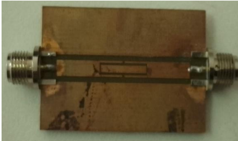
Figure 2-5 : résonateurs CPW sur substrat FR4 ( couleur jaunâtre )
