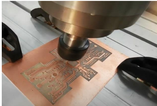
Figure 2–35 : exemple de gravure sur la couche de cuivre d'un substrat
