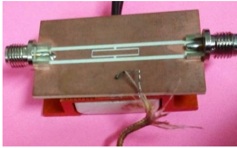
Figure 2-27 : contact direct entre capteur et résistance chauffante
