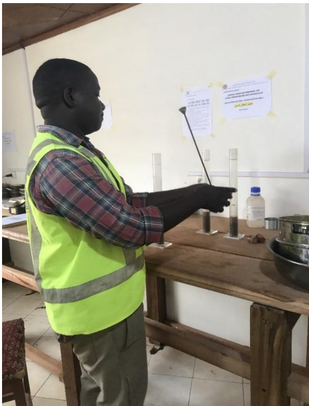
Annexe 2. Réalisation de l'équivalent de sable et détermination des hauteurs H1 et H2
