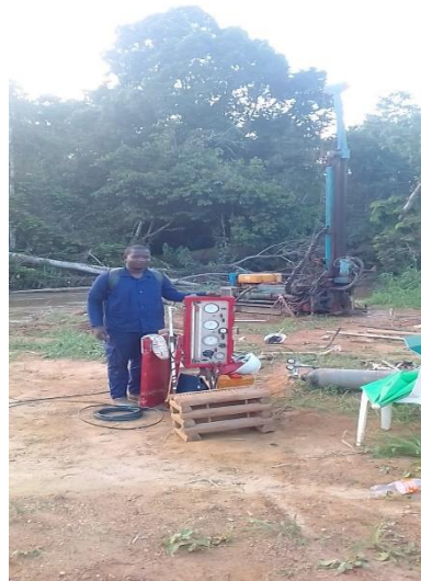
Annexe 15. Réalisation de l'essai Pressiometrique avec prélèvement des carottes de roche
