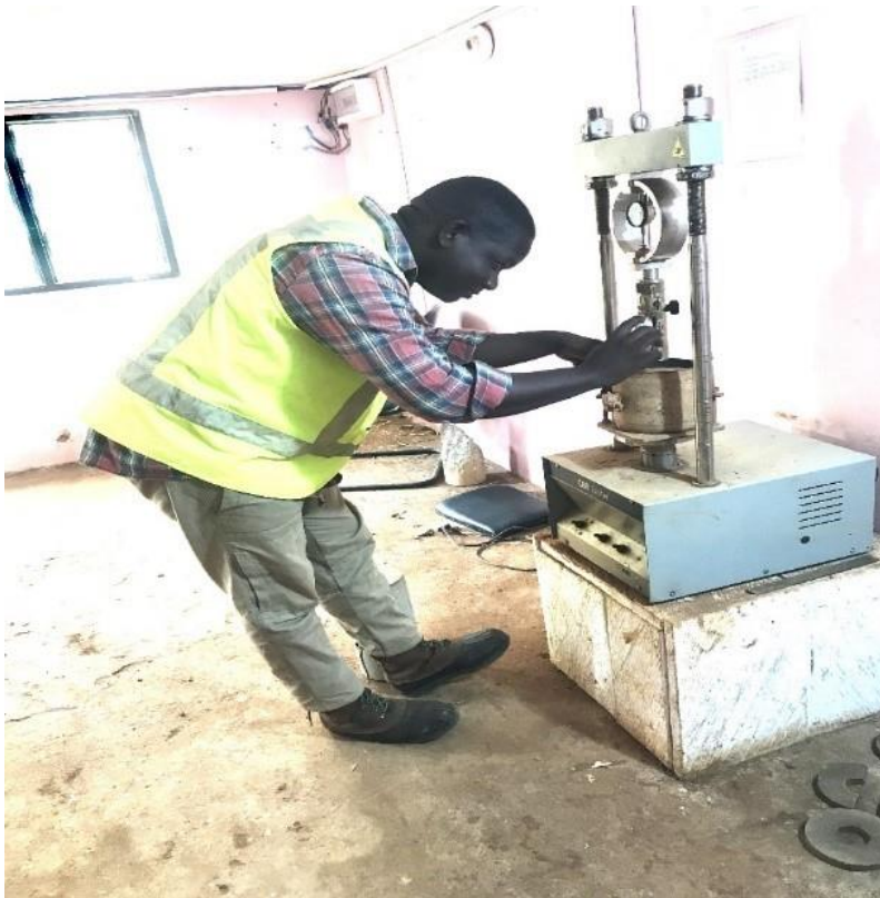
Annexe 5. Poinçonnement et Détermination de l'indice portant CBR
