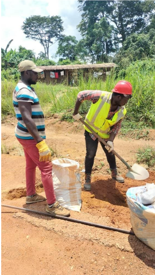
Annexe 1. Prélèvement des échantillons de graveleux latéritique dans la zone d'étude
