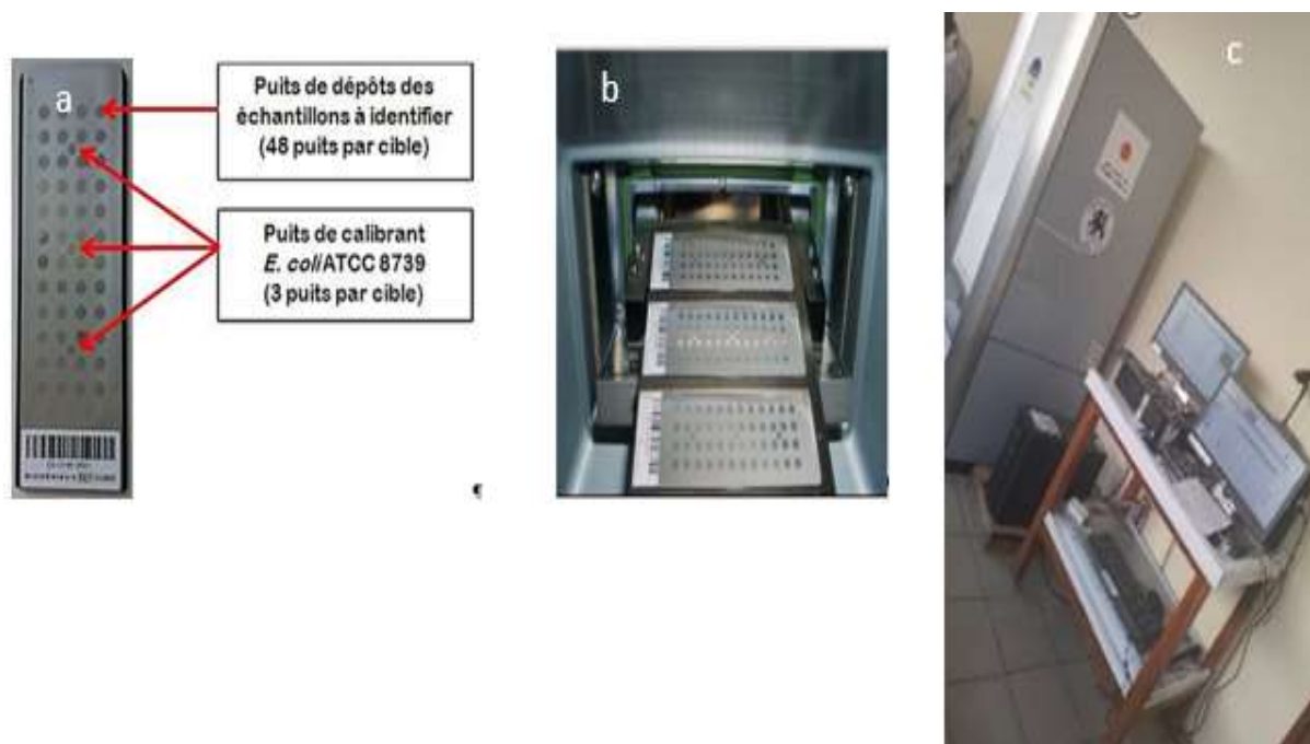
Figure 2: (a) Cible Vitek MS, (b): Introduction du portoir adaptateur de cible dans Vitek Ms, c : Automate Vitek MS (Malditof-Tof) BioMérieux (Source présente étude)
