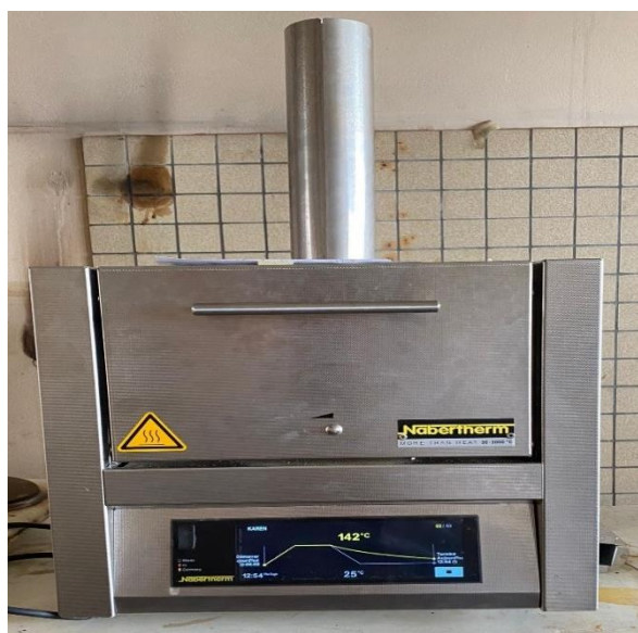
Photo 2 : Four utilisé pour la décomposition thermique des succinates métalliques
