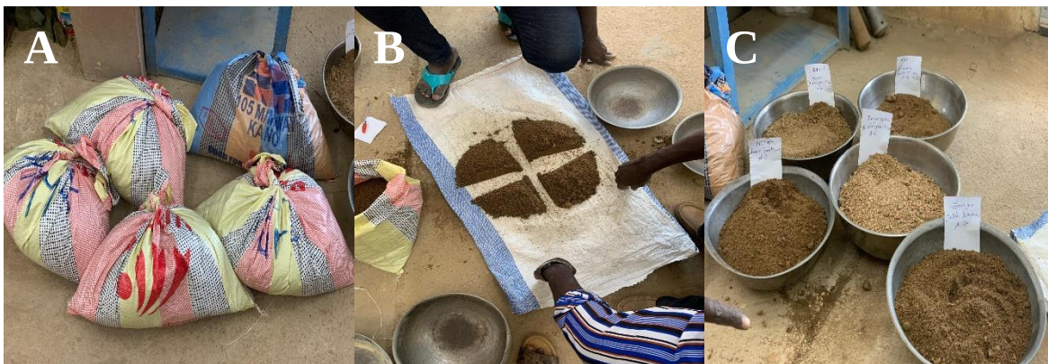
A) Les échantillons ; B) Le quartage ; C) Prélèvement des échantillons pour l'AG
