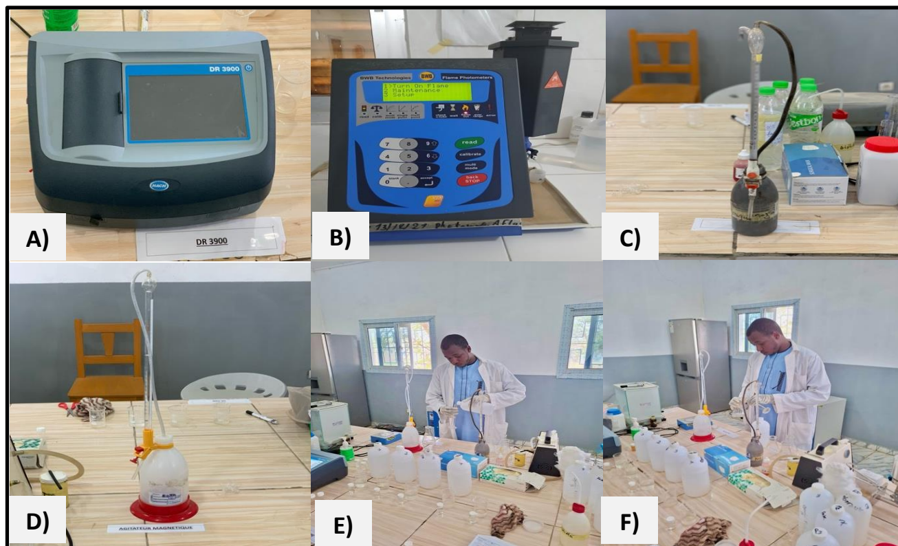
Figure 13 : Matériels utilisés en laboratoire. A) Spectrophotomètre DR3900 ; B) Photomètre à flamme distillateur ; C) Agitateur avec l'acide sulfurique ; D) Agitateur avec EDTA 0,01N ; E) 50ml d'eau versé dans la burette graduée ; F) L'eau étant dans la burette est ensuite versé dans un Erlenmeyer
