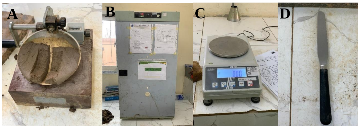
A) Appareil de Casagrande + outil à rainure + plaque lisse ; B) Etuve ; C) Balance ; D) Spatule.
