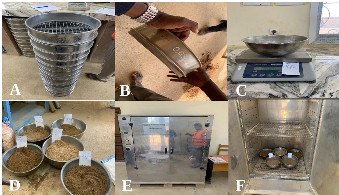
Matériels utilisés pour la réalisation d'une analyse granulométrique : A) Colonne de tamis ; B) Tamis de 0,080 mm pour l'AG ; C) Balance ; D) les tares avec les différents échantillons ; E) Etuve ; F) Assèchement des matériaux à 105°C pour une durée de 24h.
