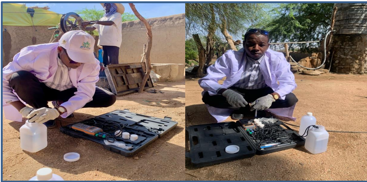
Figure 10 : Mesure in-situ des paramètres physiques de l'eau
