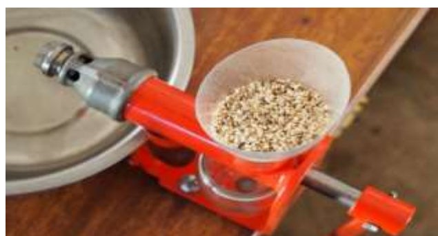
2) Les graines de sésame sont placées dans l'entonnoir qui a le bon diamètre pour s'insérer dans le trou d'entrée
