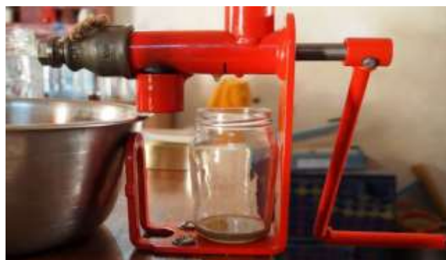
4) Enfin, très rapidement, l'huile coule par la fente et remplit progressivement le pot
